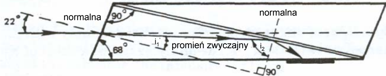
Rys. 13 Schemat biegu promienia zwyczajnego w pryzmacie Nicola
