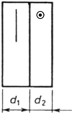
Rys. 20 Dwie płytki płaskorównoległe wycięte z kwarcu i sklejone w sposób subtraktywny (osie optyczne płytek wzajemnie prostopadle).
